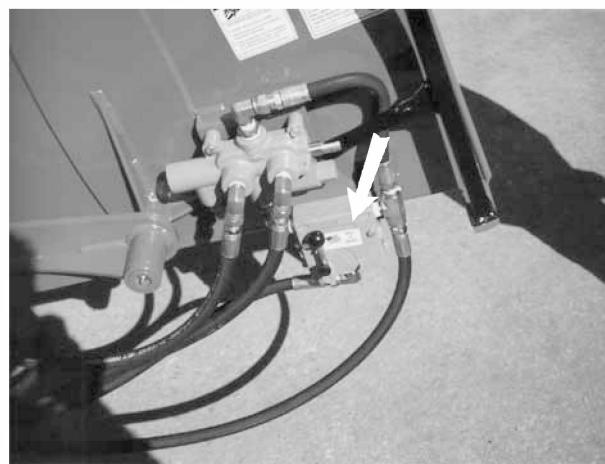
Рис. 24. Регулятор потока.
