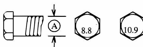
Значения, указанные выше, используются для несмазанной резьбы, если не указано дополнительно. При использовании стопорных элементов увеличивайте значение затяжки на 5%.
