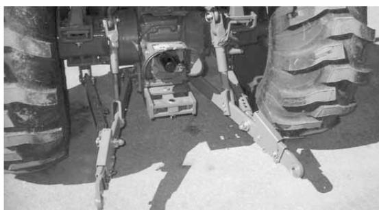
Рис. 16. Нижние рычаги трактора.
