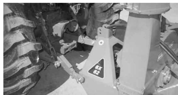
Рис. 17. Нижние рычаги в зацепленном состоянии.
