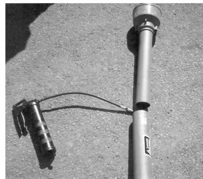
Смазка телескопической секции
