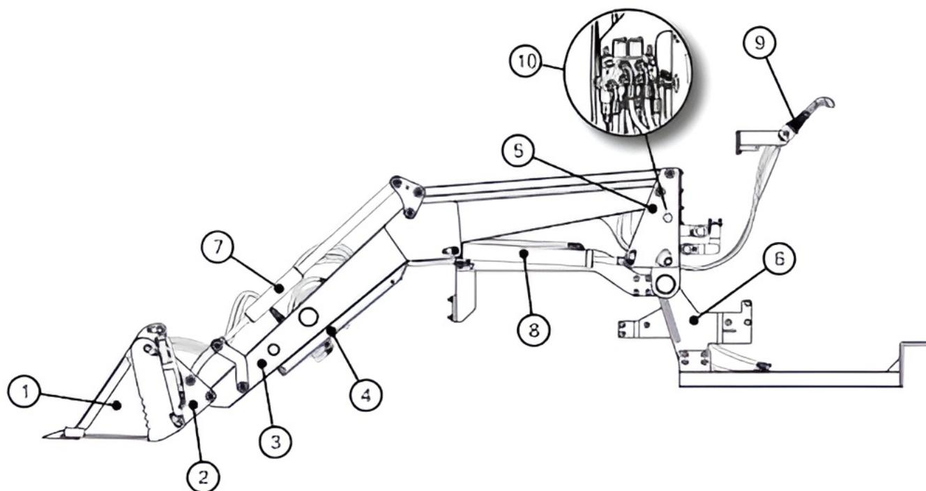
Погрузчик монтируется путем соединения плиты (5), являющейся неотъемлемой частью, с опорной рамой (6). Рабочее движение вверх-вниз стрелы (3) осуществляет цилиндр стрелы (7) – гидравлический цилиндр двухстороннего действия. Поворотное движение рамы навески (2) осуществляет цилиндр рамы (8) – гидравлический цилиндр двухстороннего действия, путем управления джойстиком из кабины трактора (9). Конструкция погрузчика оснащена опорой (4).
