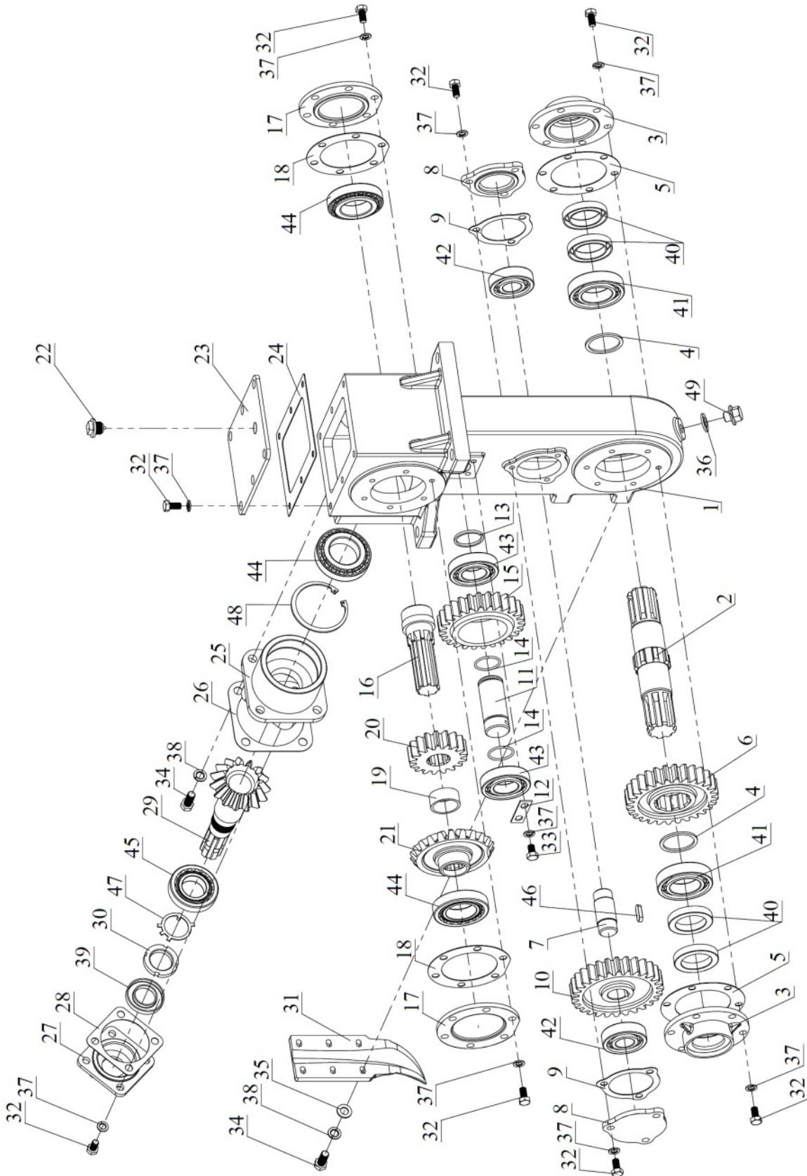
Рис. 8. Список комплектующих облегченного редуктора.
